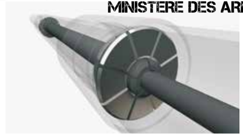
Anneaux de glissière absorbant l'énergie d'impact
